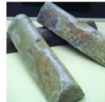
Figura 2.12 El plomo presenta aspecto grisáceo y es relativamente blando comparado con metales como el cobre y el hierro.
