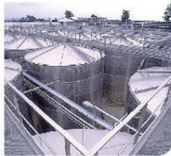
► Figura 4.12 El acero inoxidable es utilizado en la industria para fabricar silos de almacenamiento de sustancias simples e incluso corrosivas, gracias a las propiedades que adquiere el hierro después de su tratamiento.
