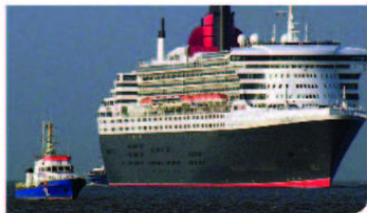
Figura 1.17 En el caso de un barco, el acero del que está hecho es más denso que el agua, por lo que podemos pensar que se hundirá; sin embargo, el barco se diseña y se construye en concordancia con el principio de Arquímedes, por eso no se hunde.
