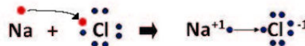
► Figura 2.25 El cloruro de sodio (NaCl) está formado por un átomo de sodio y uno de cloro. Ambos se mantienen unidos por una fuerza electrostática generada por la formación de iones producto de una transferencia de electrones.
